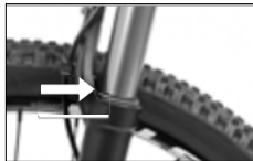
O-ring al tubo di supporto
