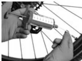
INSERIMENTO DEL LIQUIDO SIGILLANTE
