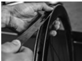
APPLICAZIONE DEL NASTRO SIGILLANTE
