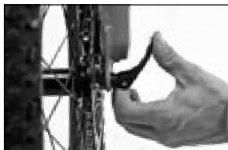
Immagine 6F(b) - Chiusura della leva Quick Release
