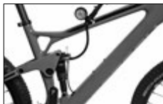
Nel caso delle sospensioni pneumatiche, sarà necessario regolare la pressione dell'aria
